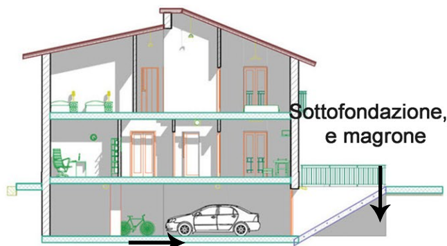
Sottofondo di pavimenti
